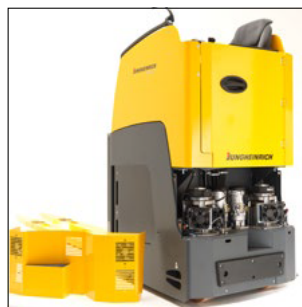
Grupos fácilmente accesibles gracias a cubiertas abatibles
